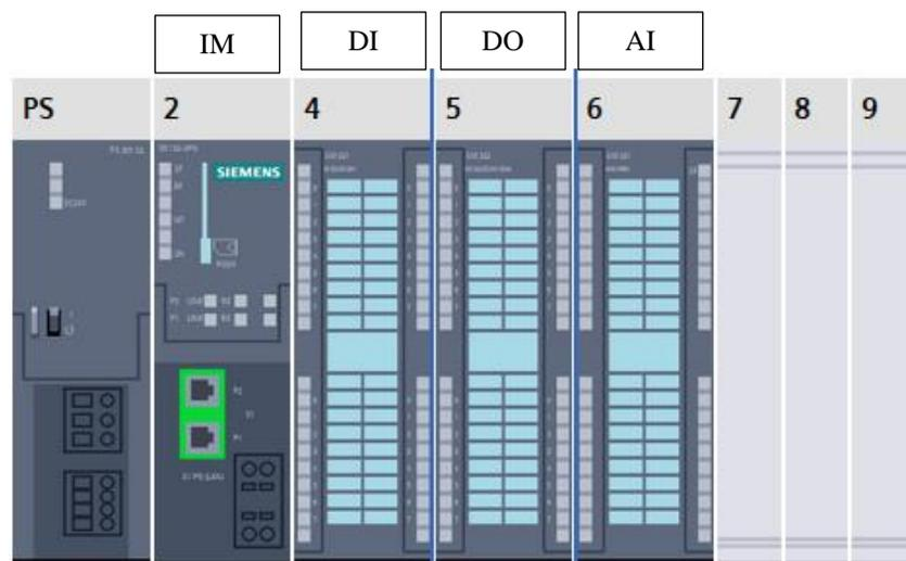
Figura 4.16.- Esquema de colocación de las tarjetas de la cabina
