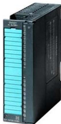
Figura 4.6.- Imagen de la tarjeta de entradas analógicas
