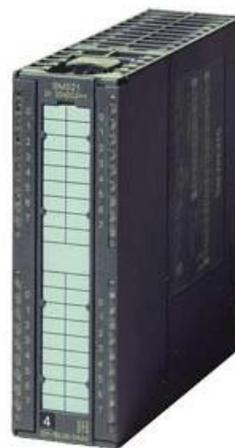
*Figura 4.5.- Imagen de la tarjeta de entradas digitales*
