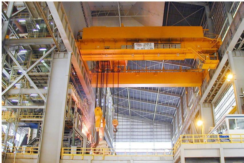
Figura 1.1.- Ejemplo de grúa para cargar un horno de la empresa Jaso
