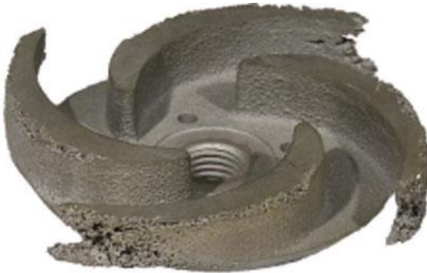
Ilustración 1: Parte de bomba rotativa afectada por la cavitación
