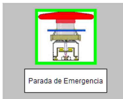
Ilustración 36: Seta de Parada de Emergencia activada
