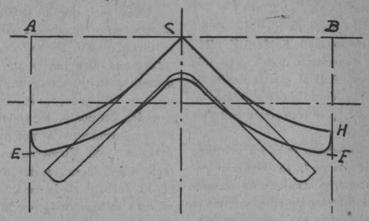
Teniendo en cuenta la contracción del metal, igual 1,015, multipliquemos todas las dimensiones por ese coeficiente y tendremos las de la canal concluidora en los cilindros.
