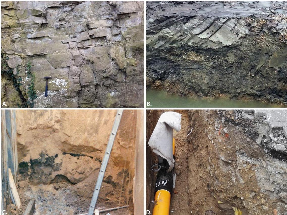
FIGURA 1.8. Materiales bajo el subsuelo de la ciudad: (A) sustrato rocoso (Fm. Gijón); (B); depósitos eluviales; (C) depósitos arenosos con fangos y (D) rellenos antrópicos.
