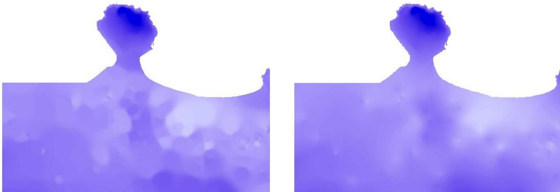
FIGURA 3.5. Comparación entre IDW (izquierda) mostrando “ojos de buey” y RBF (derecha) para la obtención del techo de la Fm. Gijón.
