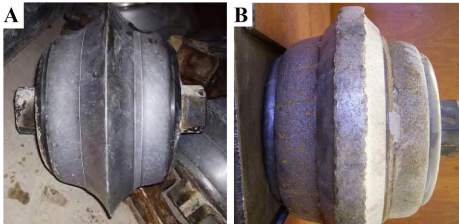
FIGURA 2.7. (A) Desgaste en forma de filo (Gutiérrez Manjón, 2005). (B) Deformaciones plásticas (Frenzel, 2011).
