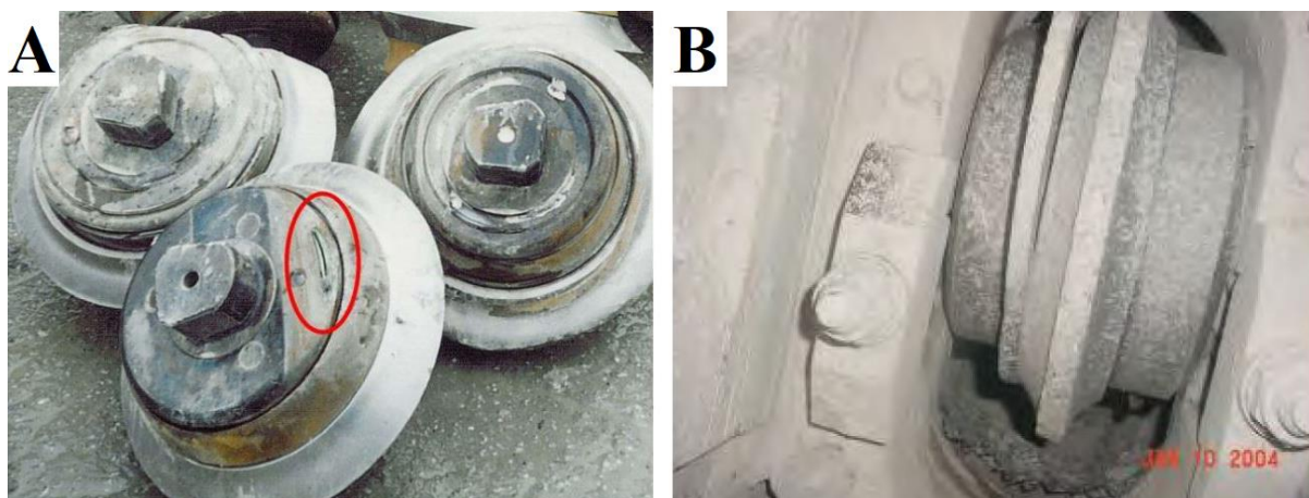
FIGURA 2.10. (A) Sello expuesto debido al desgaste secundario (Frenzel, 2011). (B) Aro de corte desplazado (Gutiérrez Manjón y García Aldaya, 2010).
