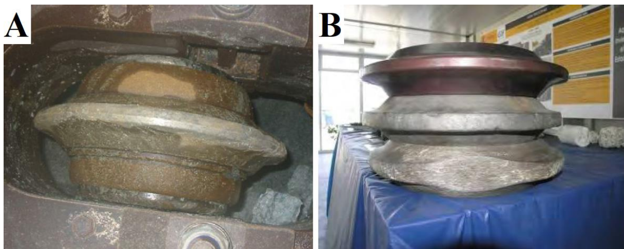
FIGURA 2.6. (A) Desgaste normal de un disco cortador (Frenzel, 2011). (B) Comparación de un disco cortador nuevo, desgastado y gripado (Gutiérrez Manjón, 2005).
