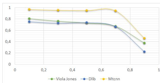
Figura 6: *Recall* obtenido por los diferentes métodos en el dataset AFW con umbrales de detección diferentes.
