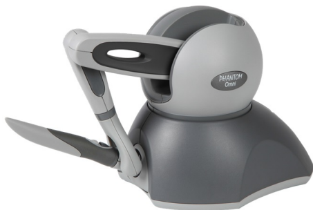
Figura 3: Dispositivo háptico Phantom Omni de SensAble utilizado como maestro en el entorno de teleoperación bajo ROS.
