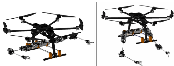
Figura 5: Posición de despegue/aterrizaje (izquierda) y posición de operación (derecha).
