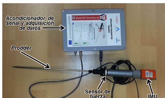
Figura 5. Vista del prodder instrumentado con la electrónica de soporte.
