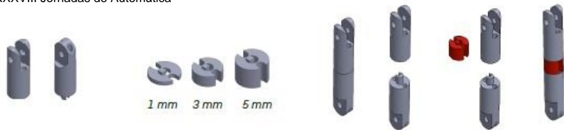
Figura 11: Posicionamiento de las piezas para el crecimiento a lo largo de las falanges.
