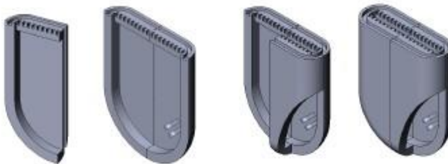
Figura 7: Montaje de las piezas fijas de la palma.
