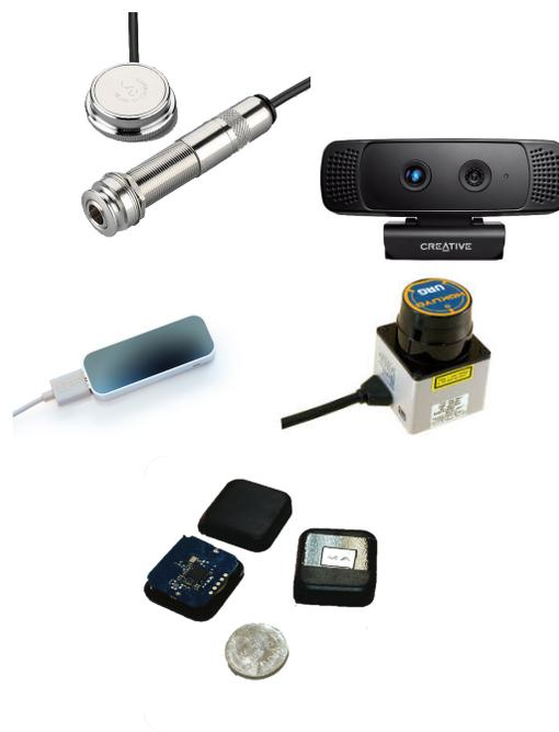
Figura 2: Principales sensores de nuestros robots: Arriba, izquierda, micrófono de contacto usado como sensor de tacto; Arriba, derecha, cámara Creative Sens3D; En el medio, izquierda, LeapMotion; En el medio, derecha, telémetro láser Hokuyo. Abajo, las balizas electrónicas.
