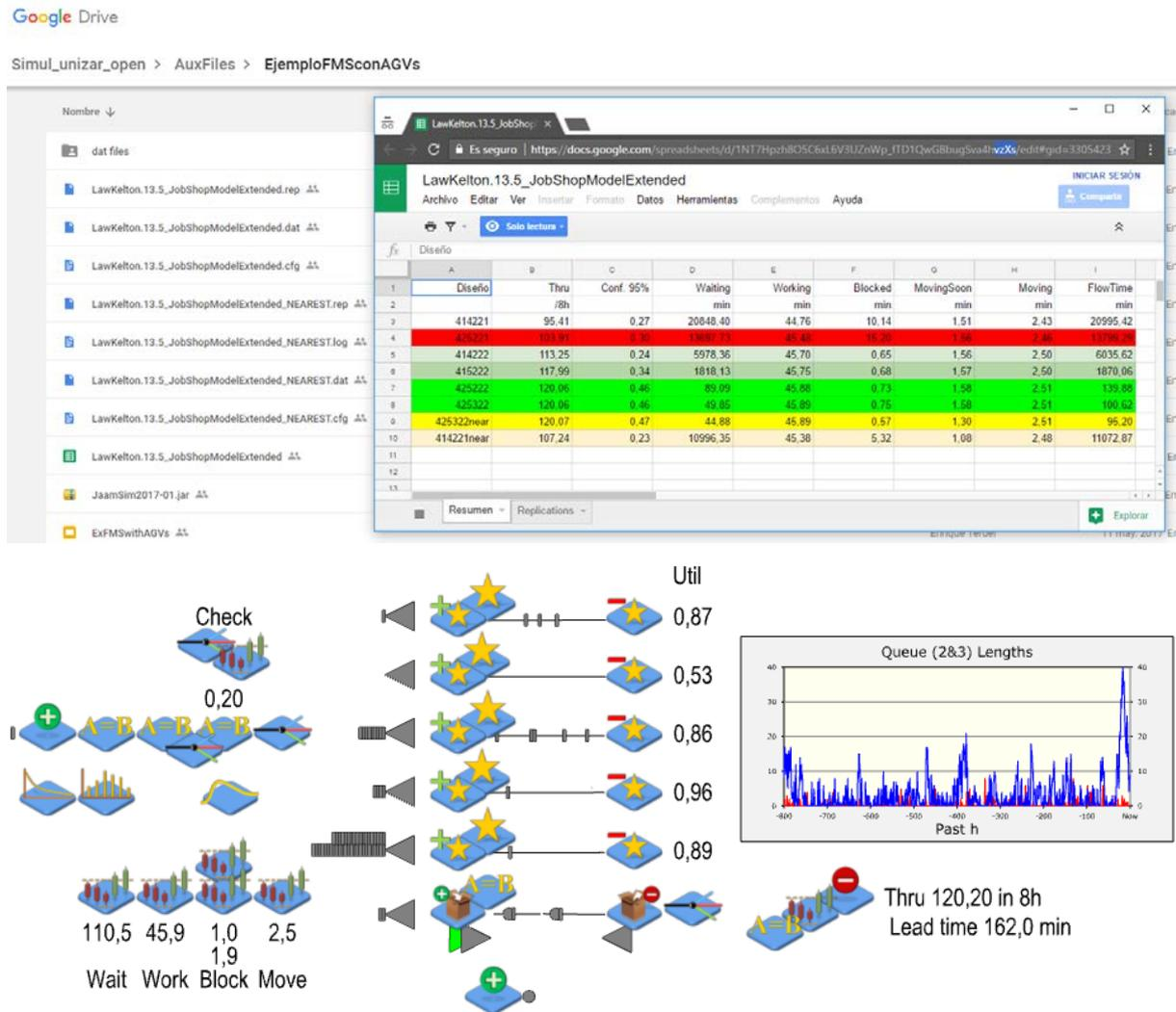
Figura 1: Ejemplo de Sistema de Fabricación Flexible con AGV's. Carpeta, hoja de cálculo con resultados y modelo funcional en JaamSim.
