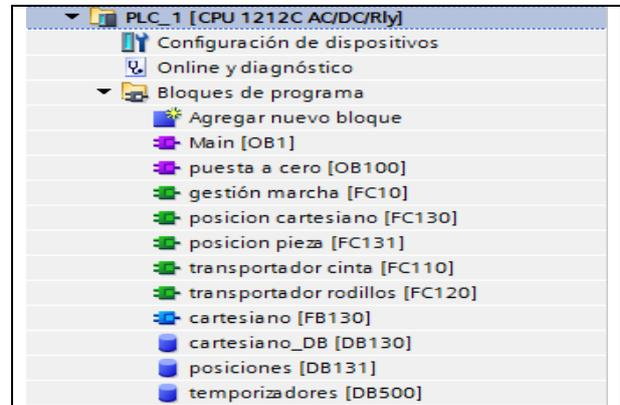
Figura 6: Bloques estación paletizadora
