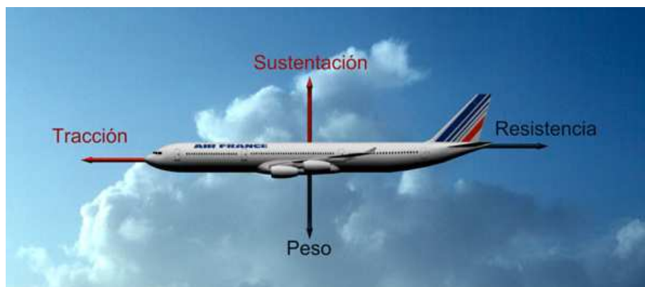
Figura 1.3.-Fuerzas de un avión el vuelo recto y nivelado
