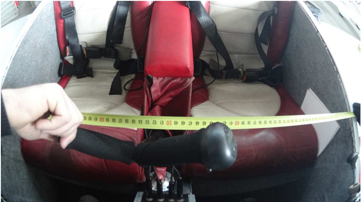
Ilustración 2.2.- Toma de medidas de los desplazamientos en tierra.
