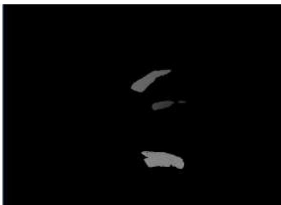
Figura 4. Imagen en la que mediante un filtro de color, se han eliminado todos aquellos elementos que no correspondan a los dedos. Esto permite disminuir significativamente el número de elementos en la nube de puntos y trabajar con componentes conexas que aproximaremos a cilindros.
