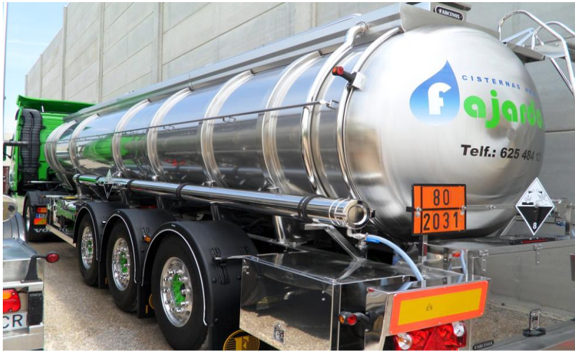
Unidad de transporte formada por una cabeza tractora y un semirremolque cisterna para ácido.
