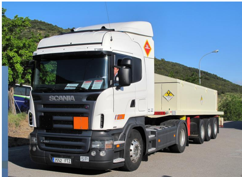
Vehículo equipado con contenedor para transporte de radioactivos de baja actividad
