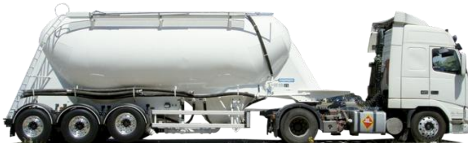
Unidad de transporte formada por cabeza tractora y semirremolque silo para productos pulverulentos.
