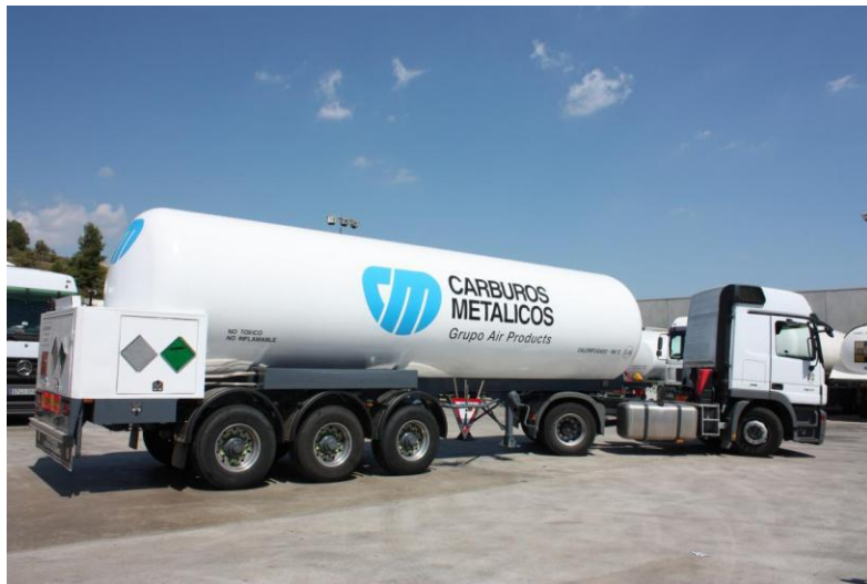
Unidad para el transporte de gases como por ejemplo el oxígeno líquido refrigerado.
