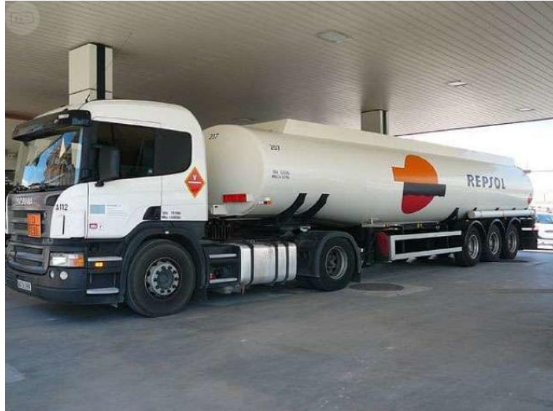
Unidad de transporte formada por una cabeza tractora y un semirremolque cisterna para combustibles.
