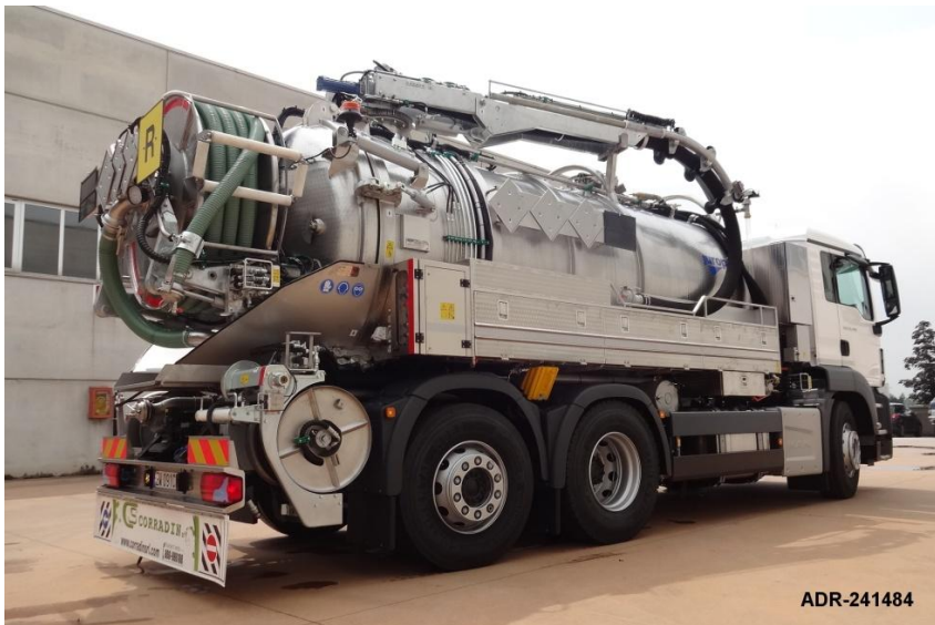
Vehículo preparado para la succión de materias líquidas. Los depósitos que incorpora no suelen ser de gran capacidad puesto que su función no es el transporte en sí, si no la limpieza de fosas, vertidos, silos...
