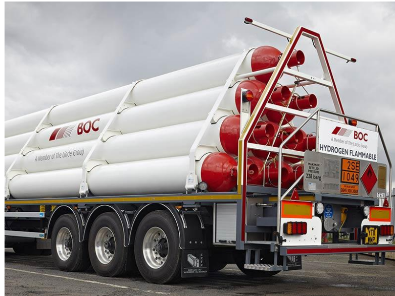
Vehículo CGEM (Contenedor de gas con elementos múltiples): Elemento de transporte que comprende elementos conectados entre sí por una tubería colectora y montados en un cuadro.
