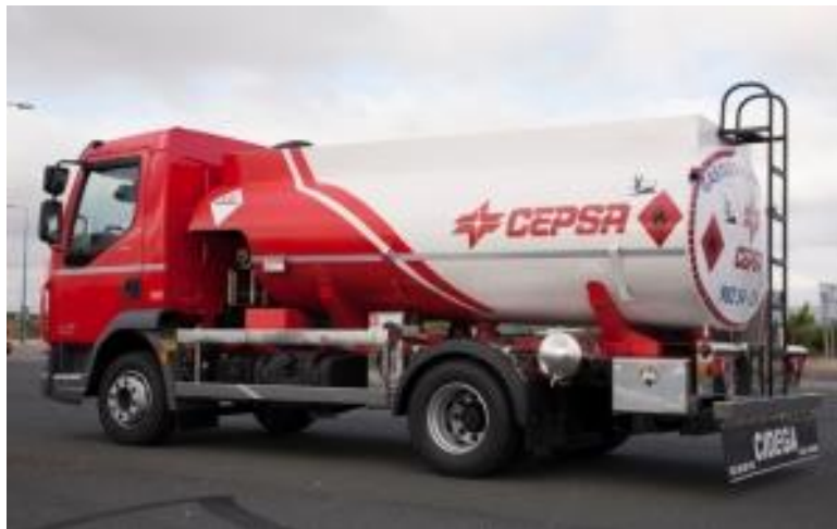
Cisterna fija para reparto a pequeña escala (comunidades, chalets,...) de gasóleo. En este caso la tractora y la cisterna comparten chasis. Es un vehículo rígido.
