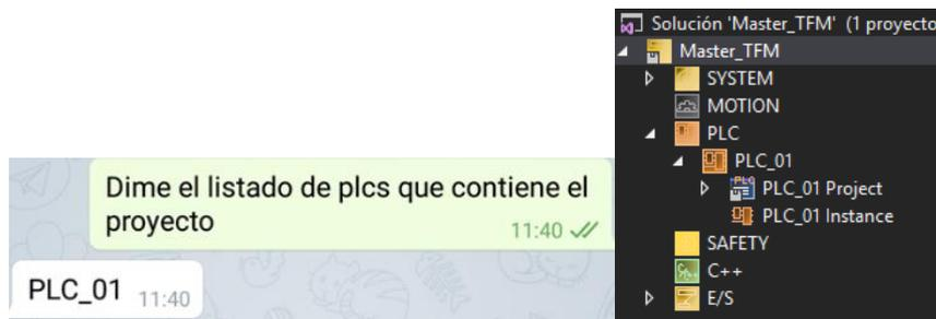
Figura 6.44.- Obtención del listado de PLCs de un proyecto de Twincat.
