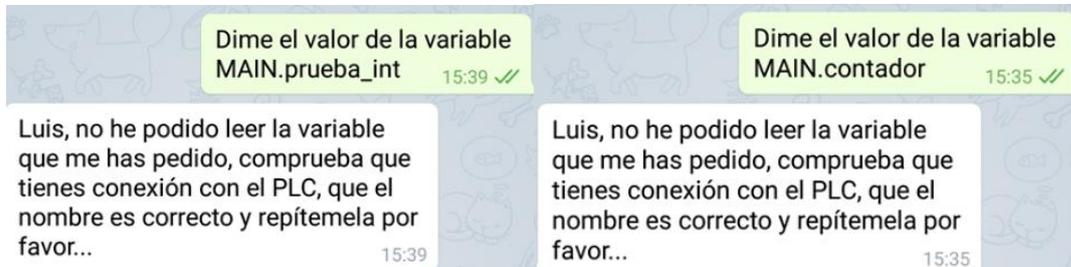
Figura 6.8.- La variable “prueba\_int” existe en el PLC pero para demostrar el ejemplo se ha cerrado la conexión con este, por lo tanto el bot informa del “fallo”. A la derecha se observa la respuesta ante una variable que de verdad no existe.
