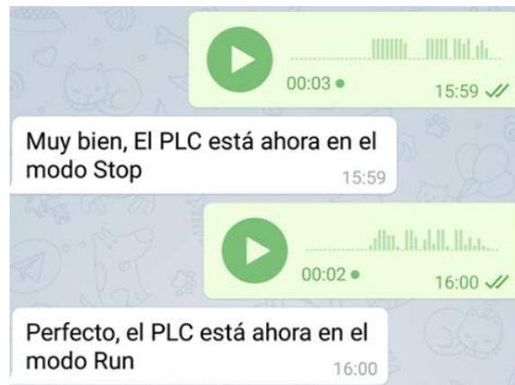
Figura 6.55.- Arranque y parada del PLC por voz.
