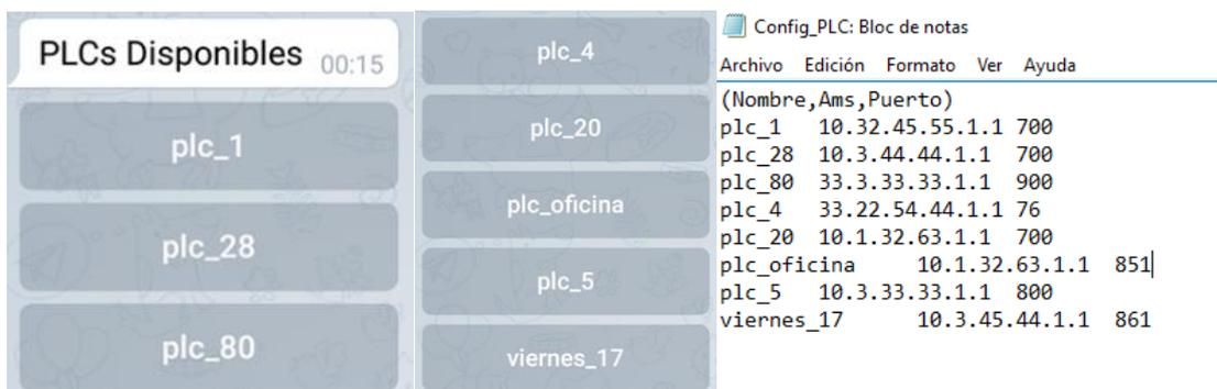
Figura 6.27.- Obtención del teclado que muestra el listado de PLCs del archivo de configuración. A la derecha se observa que los PLCs del txt son los que efectivamente muestra el bot.
