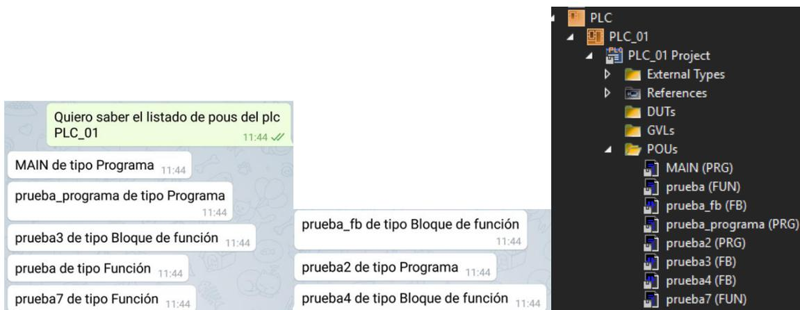
Figura 6.49.- En las imágenes de la izquierda y central se obtiene el listado de POU's del PLC solicitado. En la imagen de la derecha se comprueba que efectivamente los POU's devueltos existen en el PLC.
