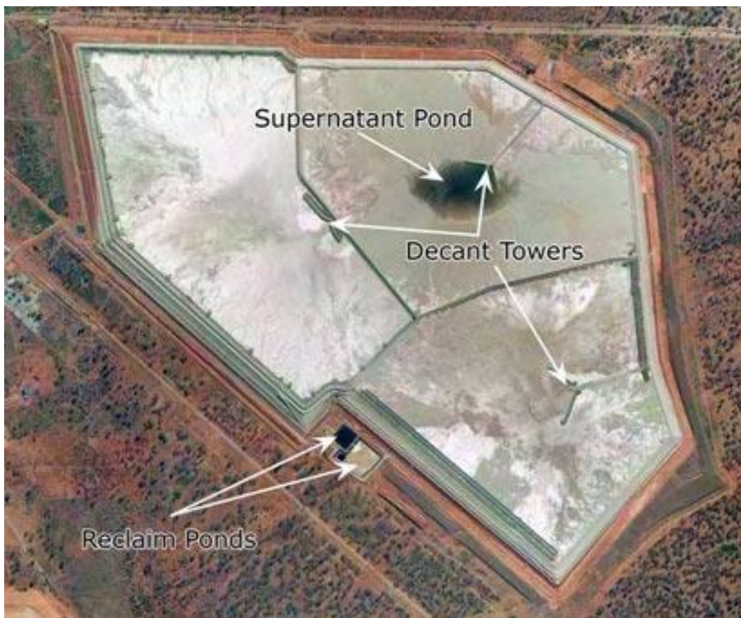
Figura 2: Configuración de dique de anillo (disposición en tres celdas) en Kalgoorlie Consolidated Gold Mines, Australia Occidental
