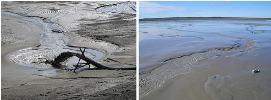
Figura 9: Descarga subaérea de relaves (izquierda) y corrientes trenzadas poco profundas de baja velocidad en una playa de relaves (derecha) (Jon Engels)
