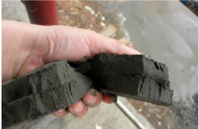
Figura 33: Consistencia de los relaves filtrados (RET, 2007)
