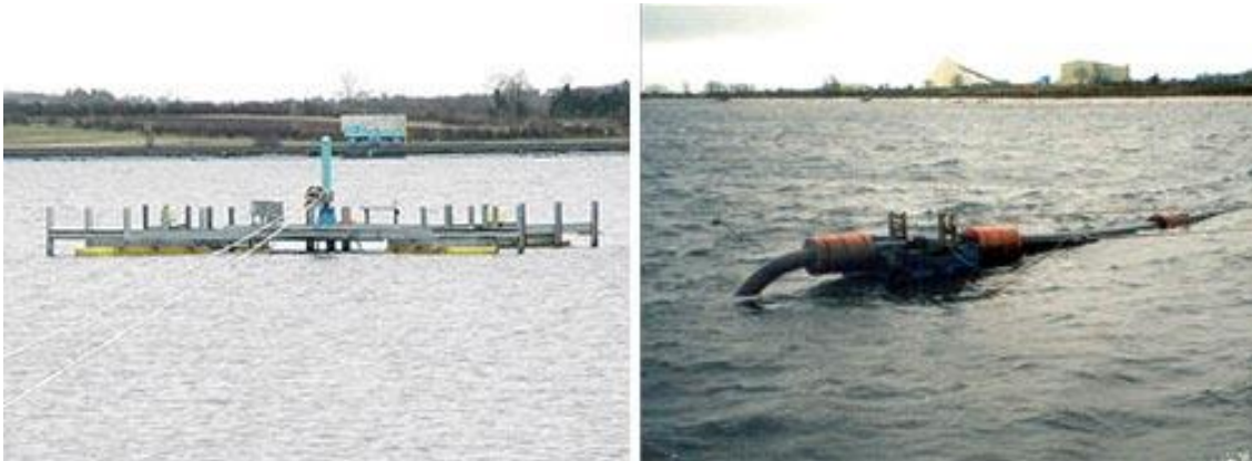
Figura 10: Deposición subacuosa de relaves convencionales (Fuente: Jon Engels)
