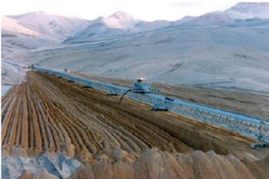
Figura 18: Pilas secas, relaves filtrados transportados mediante cinta transportadora y compactados mediante topadora, (Australian Government, 2016)
