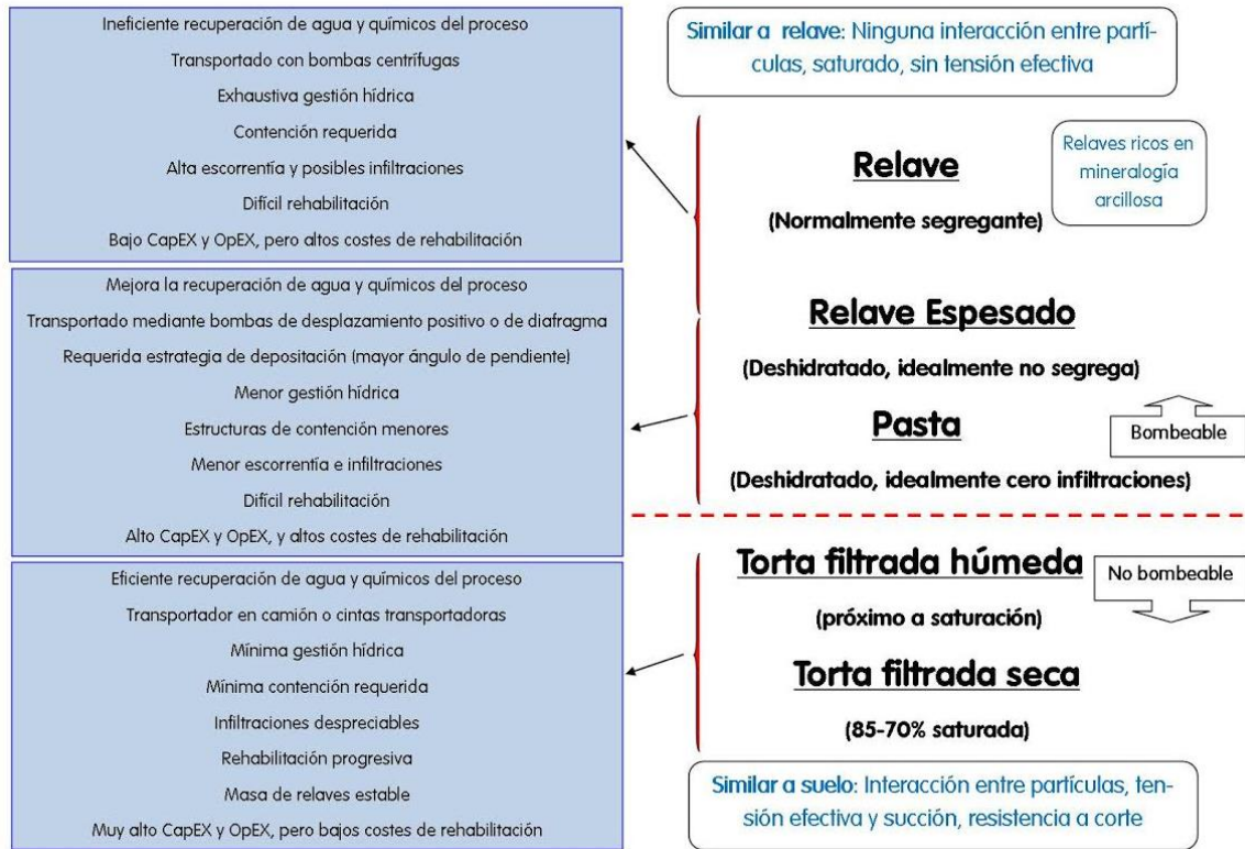
Figura 19: Tipos de relaves y sus transportes (adaptado de Davies and Rice (2004)).
