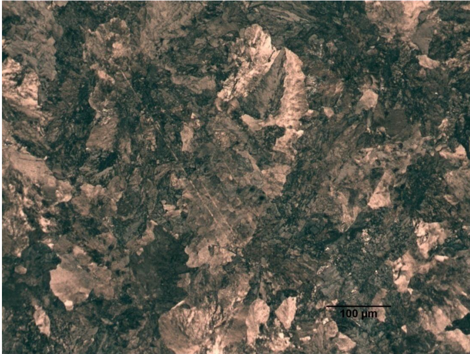
Fig. 4.10. Microestructura perlítica en el acero R260.
