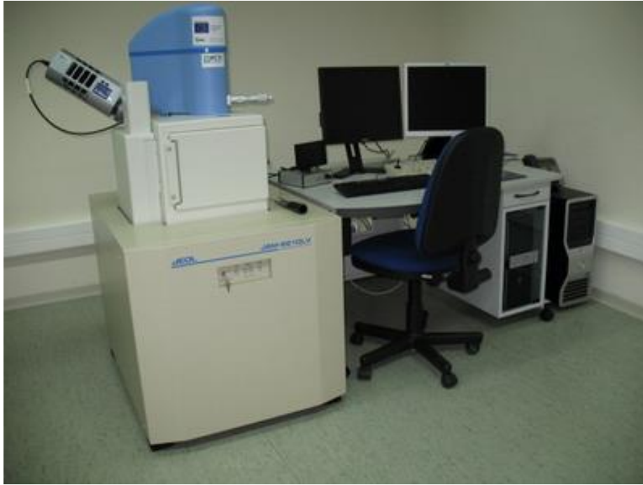
Fig. 3.31. Microscopio MEB JEOL-6610LV con microanálisis.
