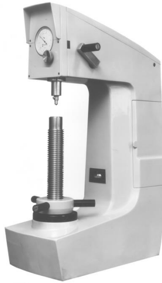
Fig. 3.6. Durómetro Hoytom 1003A utilizado sobre las muestras del carril.
