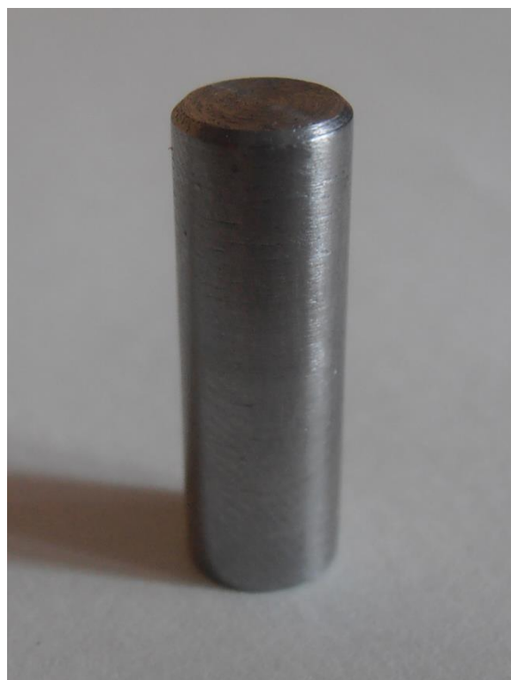
Fig. 3.5. Imagen de la probeta de acero R260 y microaleado que representan al carril.
