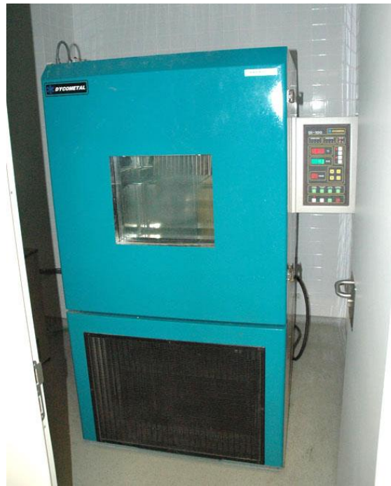
Fig. 3.32. Cámara climática (Foto por cortesía de la Fundación ITMA)
