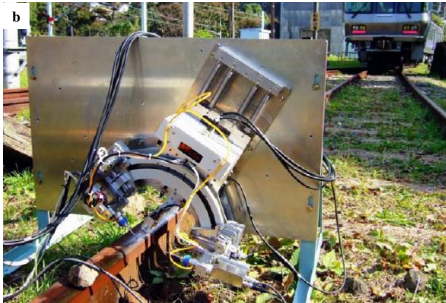
Fig. 2.19. Difracción de Rayos X para analizar el óxido del carril a) vía en recta b) vía en curva
