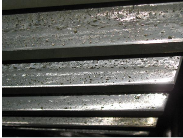
Fig. 3.17. Picaduras sobre cojinetes originadas por fatiga.
