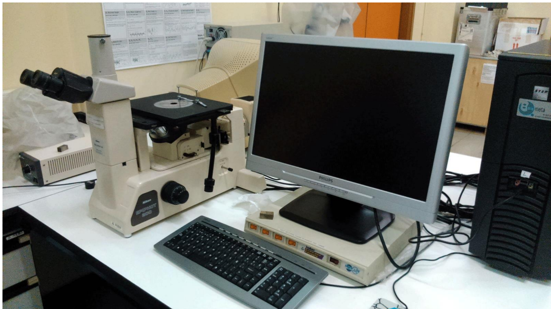
Fig. 3.8. Microscopio óptico Nikon EIPHOT 200.
