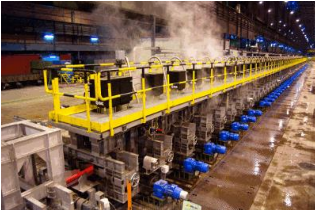
Fig. 2.15. Líneas de enfriamiento de los carriles de cabeza endurecida
