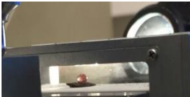
Figura 12. Método de medida de ángulo de contacto.
