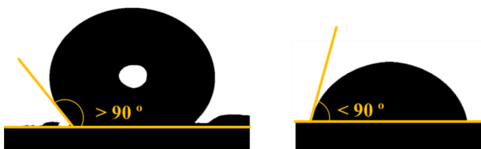
Figura 11. Medida del ángulo de contacto de un xerogel hidrófobo (izq) y otro hidrófilo (dcha) con una gota de agua.
