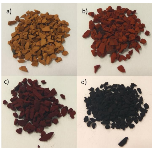
Figura 4. a), b) y c) Xerogeles orgánicos con distintas texturas porosas y d) xerogel de carbono.
