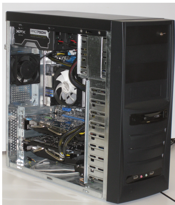
Figura A.5: Detalle de los componentes de la estación de trabajo Barracuda. Sistema heterogéneo con una CPU multi-núcleo y dos GPU de la serie Fermi.
