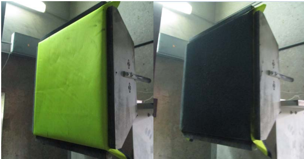
Figura 46. Muestra antes del ensayo y después del ensayo para materiales. UNE-EN 61482-1-2:2015 (fuente: AITEX)
