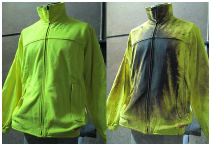
Figura 48. Muestra antes del ensayo y después del ensayo para prendas. UNE-EN 61482-1-2:2015. (fuente: AITEX)
