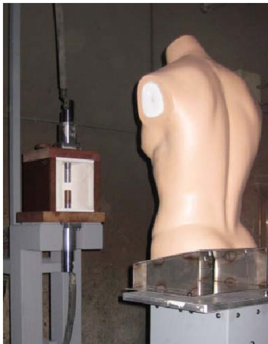
Figura 47. Montaje de ensayo real para prendas. UNE-EN 61482-1-2:2015 (fuente: AITEX)
