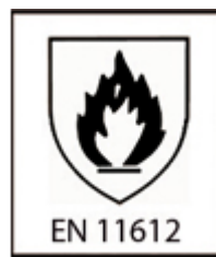
Figura 28. Pictograma de la ropa de protección contra el calor y la llama (UNE-EN ISO 11612:2008)
