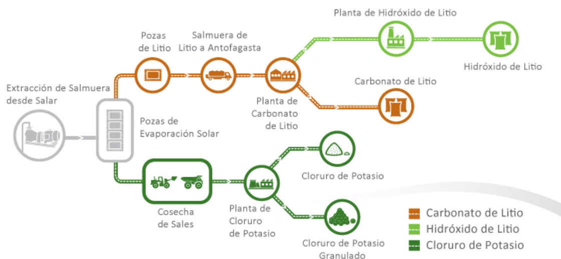
Figura 2.15: Detalle del proceso Rockwood de extracción de litio en Antofagasta, Chile.
