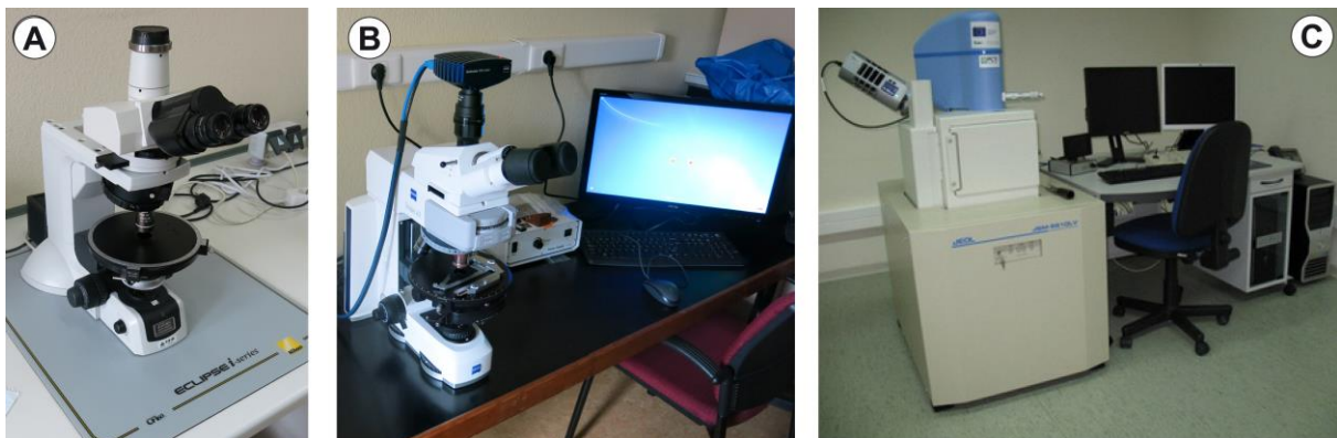
Figura 11. A) Microscopio Nikon Eclipse LV100POL del Área de Estratigrafía y Sedimentología, utilizado para el análisis petrográfico a x2, x4 y x10 aumentos. B) Imagen del equipo ZEISS utilizado para el análisis de las inclusiones a x40 aumentos, microscopio Axio Scope.A1 Pol y cámara AxioCam 506 color. C) Microscopio electrónico de barrido MEB JEOL-6610LV usado para el estudio de las inclusiones.
