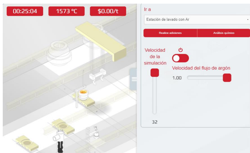
Figura 35. Pantalla de control de la estación de lavado con argón en el simulador
