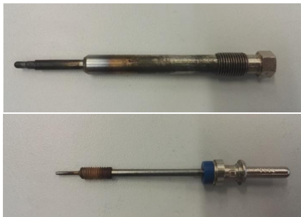
Ilustración 3. En la parte superior la parte cerámica (situada dentro del casquillo metálico), en la inferior la parte metálica de una bujía.
