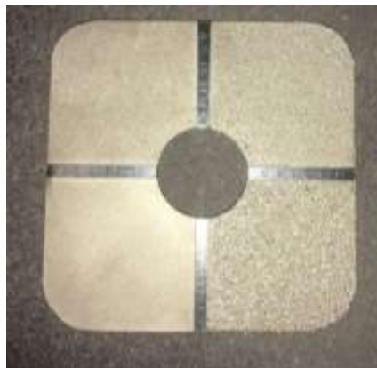
Figura 37. Rugosidad obtenida tras el chorreado con escoria BOF obtenida del primer tamizado
