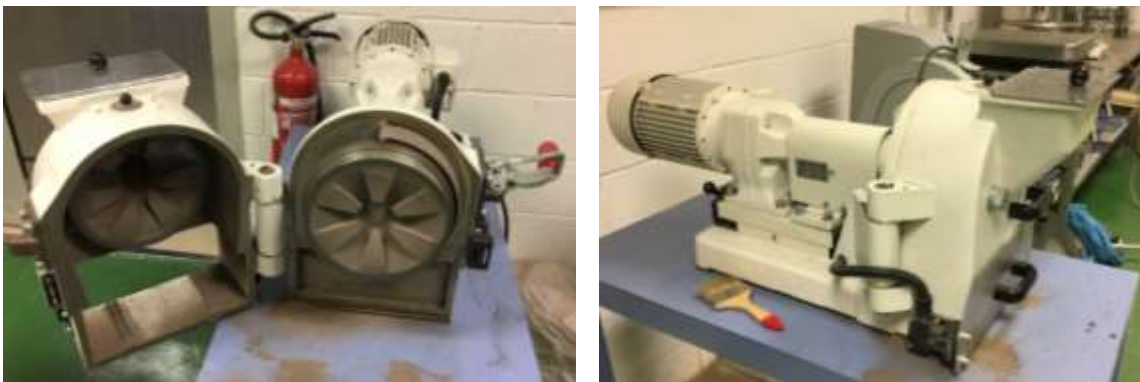
Figura 27. Molino de discos Pulverisette 13 (marca Fritsch ), abierto y cerrado
