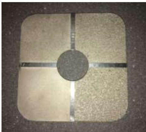
Figura 39. Rugosidad obtenida tras el chorreado con escoria BOF obtenida mediante tamizado – molienda – retamizado
