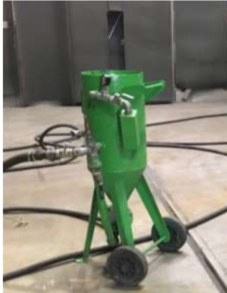
Figura 31. Arenero empleado en el segundo ensayo
