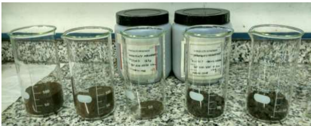
Figura 40. Muestras de 100 g de escoria BOF (la muestra de 5 g fue descartada)
