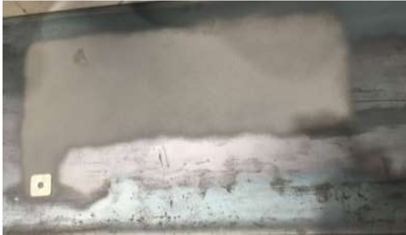
Figura 38. Estado de la lámina de acero tras el chorreado con escoria obtenida mediante tamizado – molienda – retamizado
