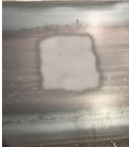
Figura 23. Chapa de acero tras la aplicación de la escoria BF como abrasivo
