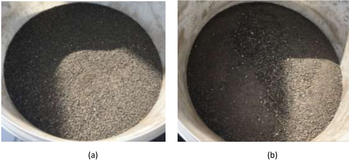
Figura 29. Muestra testada: (a) Fracción granulométrica 2 – 0,2 mm de escoria BOF obtenida mediante tamizado-trituración-retamizado. (b) Fracción granulométrica 2 – 0,2 mm de escoria BOF obtenida mediante tamizado
