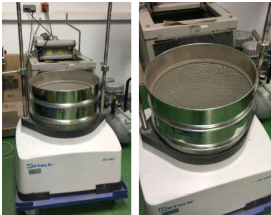
Figura 25. Tamizadora Retsch AS 450 control empleada en el tratamiento de la escoria
