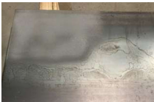
Figura 22. Chapa de acero tras la aplicación de la escoria BOF como abrasivo
