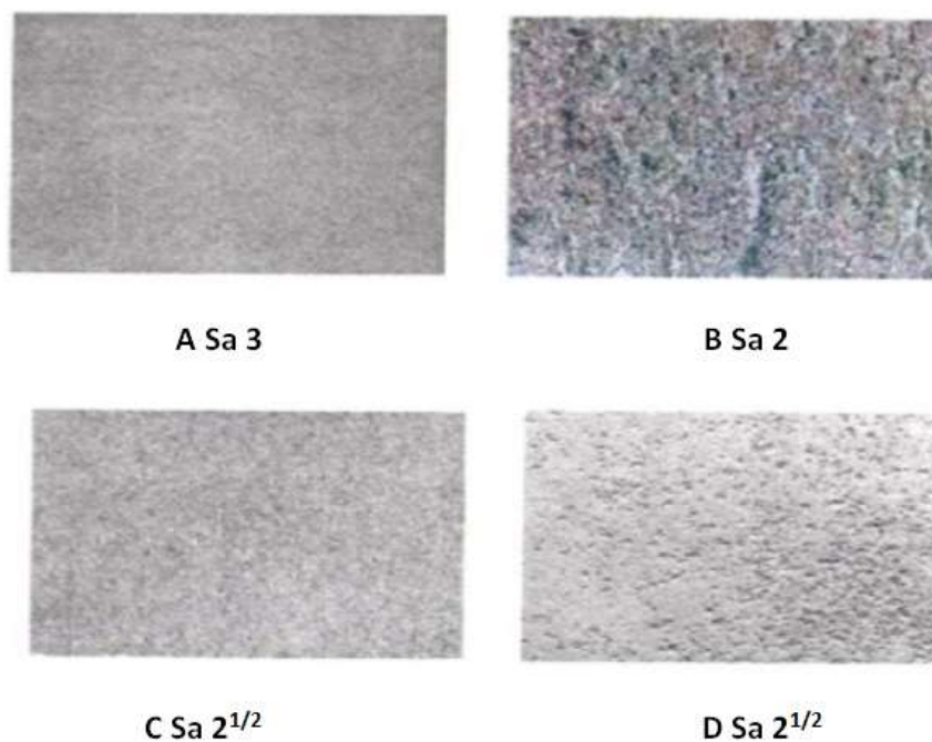
Figura 7. Patrones fotográficos de los grados de preparación de superficie [23]
