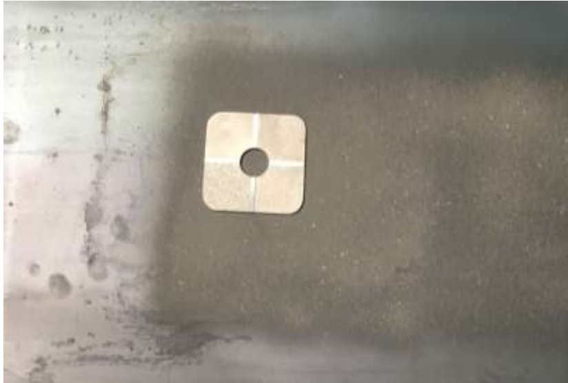
Figura 32. Estado de la lámina de acero tras el chorreado con escoria obtenida del primer tamizado
