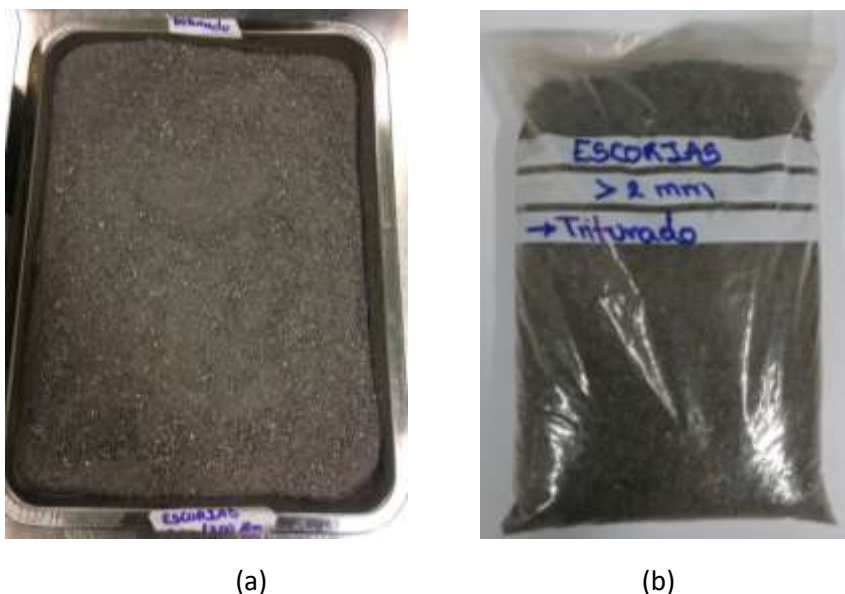
Figura 28. Escoria BOF. (a) Fracción 2000 – 200 \mu\text{m} de tamizado – molienda – retamizado. (b) Fracción >2000 \mu\text{m} de tamizado – molienda – retamizado
