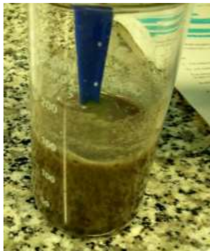
Figura 42. Mezcla de la escoria BOF
