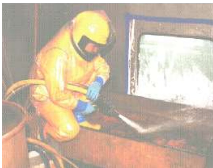
Figura 48. Operador desarrollando tareas de chorreado abrasivo en húmedo para descontaminación de grandes piezas [79]
