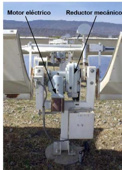
Figura 4.5. Sistema de seguimiento solar con mecanismo eléctrico [9]
