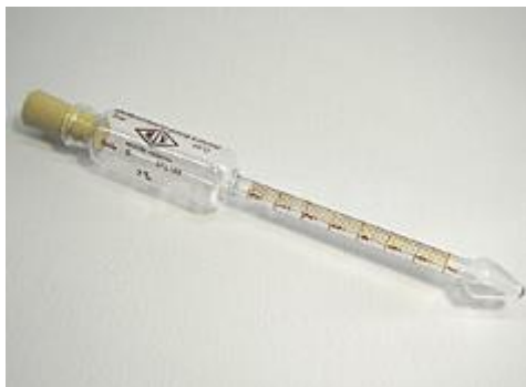
Figura 7. Butirómetro tipo Gerber para leche, 0 a 7% de grasa.
