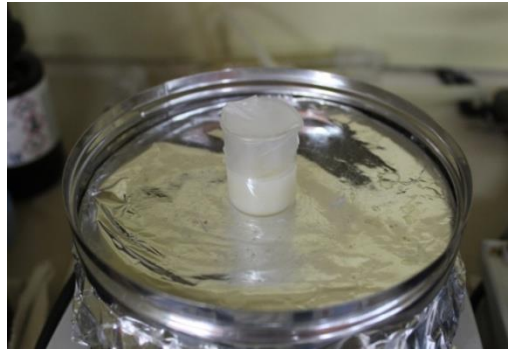
Figura 2A1. Disolución de SPI, agua, etanol, \beta -caroteno y glutaraldehído antes de la formación de las nanopartículas.
