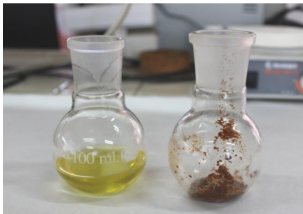
Figura1A1. Extracto de magaya suspendido en etanol (matraz a la izquierda) y precipitado solido tras el tratamiento de la muestra con ultrasonidos (matraz a la derecha).
