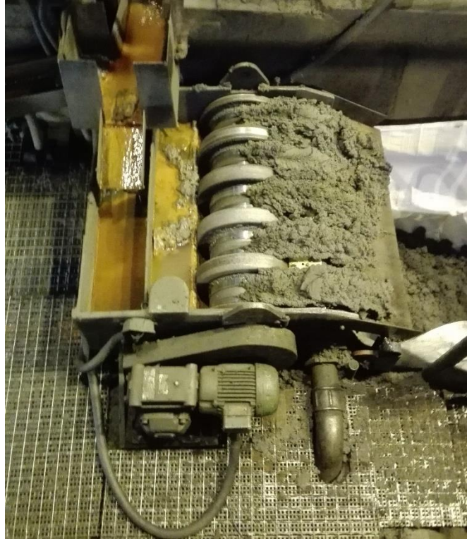
Figura 3.5 Separador magnético rectificadora
