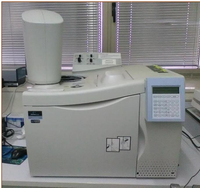
**Figura 30. Cromatógrafo de gases CLARUS 400 (Perkin Elmer)**
