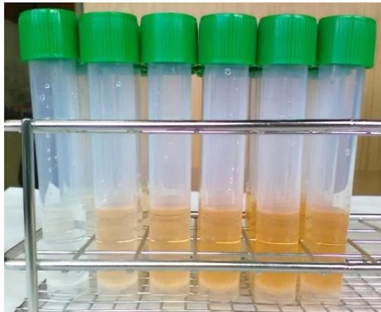
**Figura 25. Patrones de glucosa para realizar la curva de calibrado de los azúcares totales. De izquierda a derecha, las muestras corresponden al blanco, patrón de 20 ppm, de 40, de 60, 80 y 100 ppm.**
