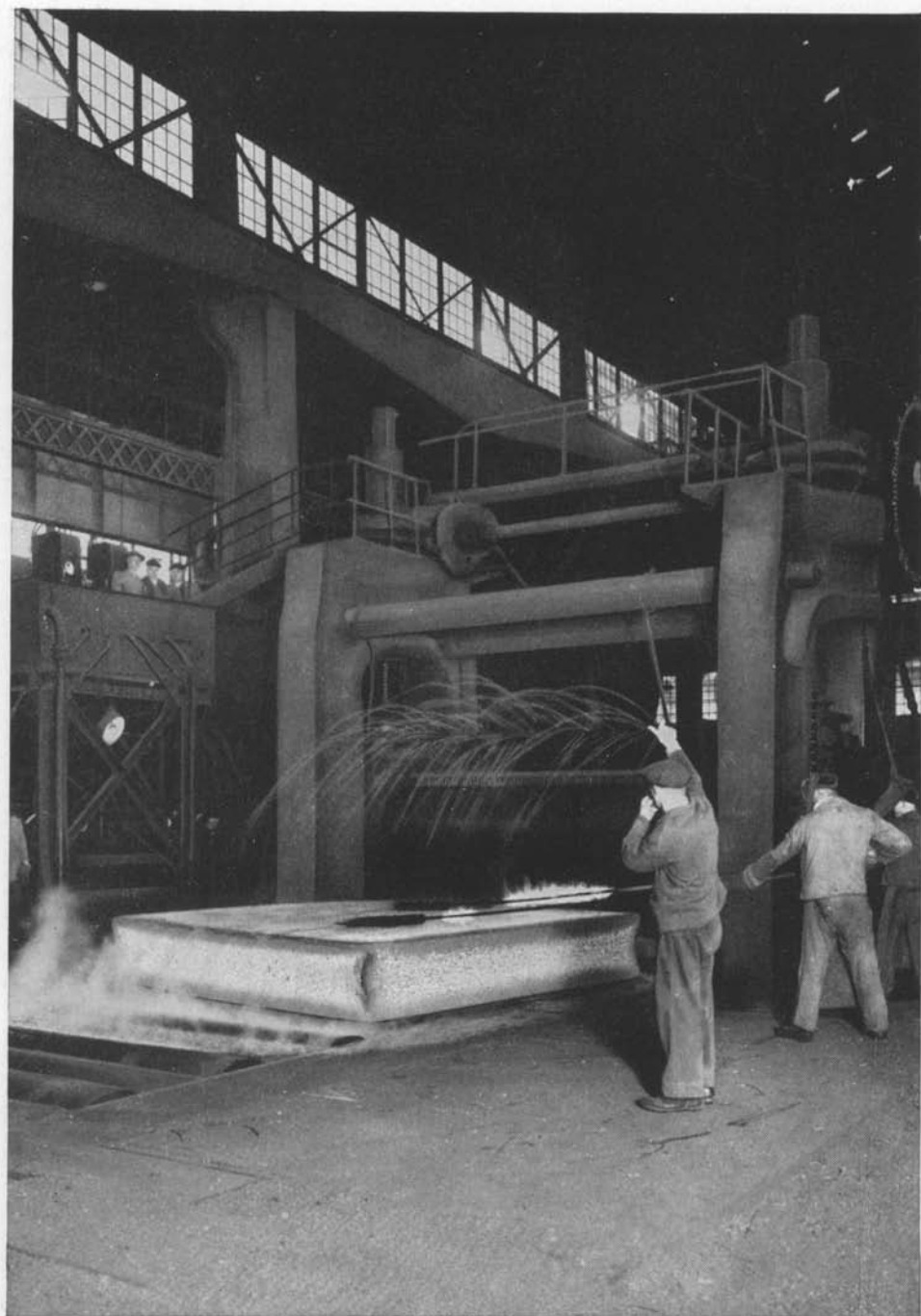
Una chapa de blindaje es laminada
