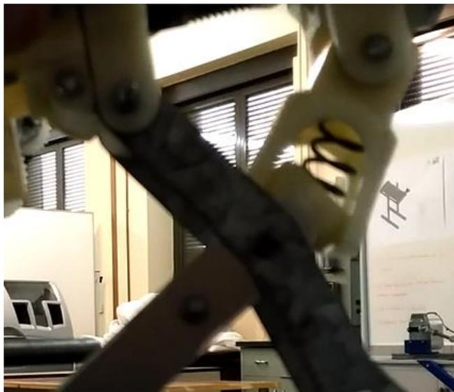
Figura 6.15 Deformación del muelle debido a colocación en mala posición.
