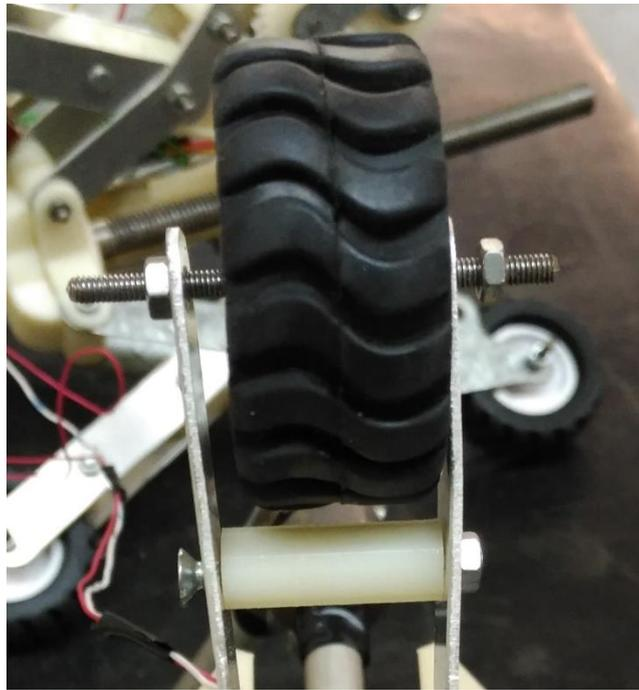
Figura 6.14 Deformación axial de los brazos.
