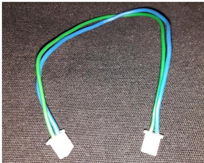
Figura 9.22 Cable con terminal JST de conexión.
