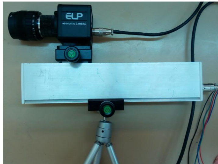
Ilustración 71 Resultado final del carril de enfoque
