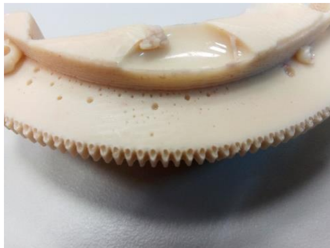
Ilustración 51 Pieza con burbujas resultado de colada simple
