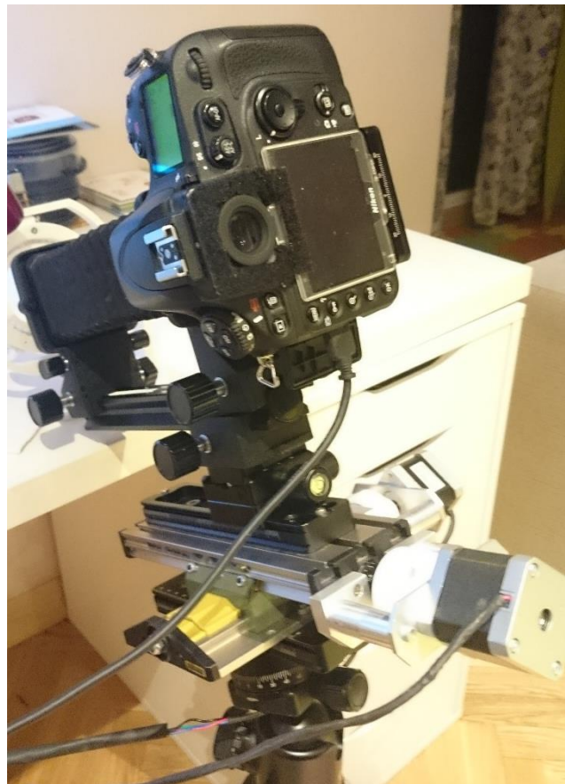
Ilustración 29 Carril de enfoque con Proxxon KT70
