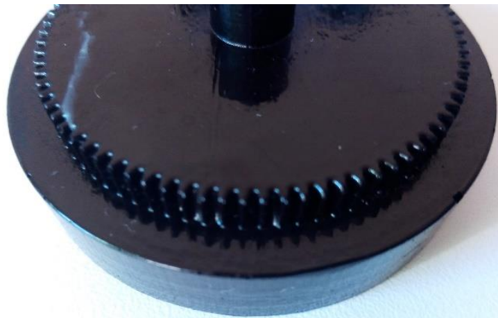
Ilustración 54 Resultado con defectos de detalle
