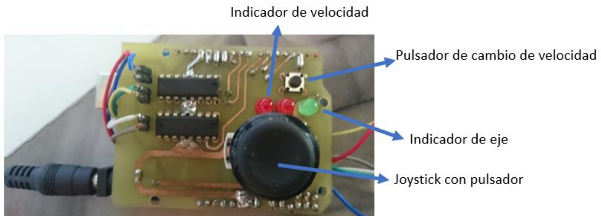
Ilustración 37 Electrónica propia del primer prototipo
