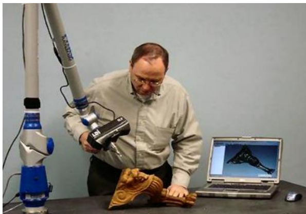
Ilustración 1 Contacto discreto con activación manual
