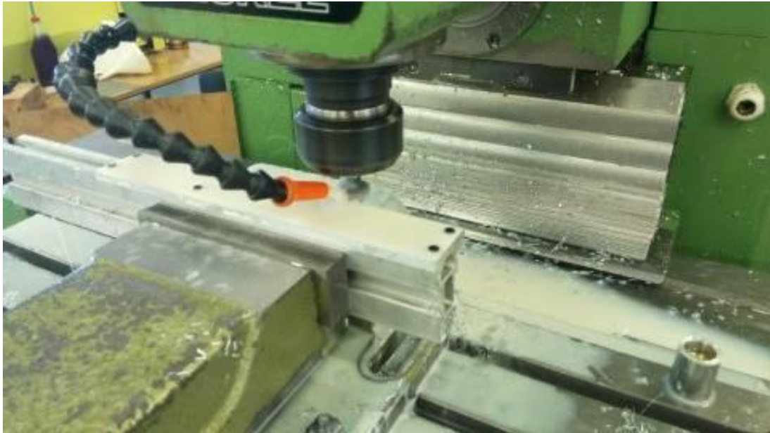
Ilustración 58 Mecanizado en fresadora de chapa Arca Swiss
