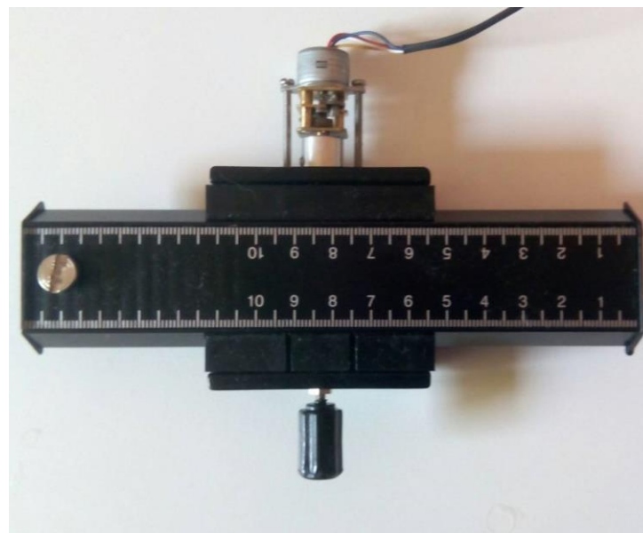
Ilustración 31 Carril de enfoque comercial motorizado
