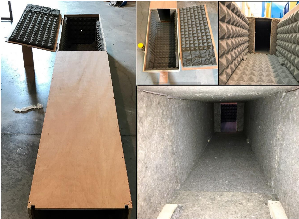
Figura 36. Vista general de la cámara aislada junto con los detalles de las distintas partes.
