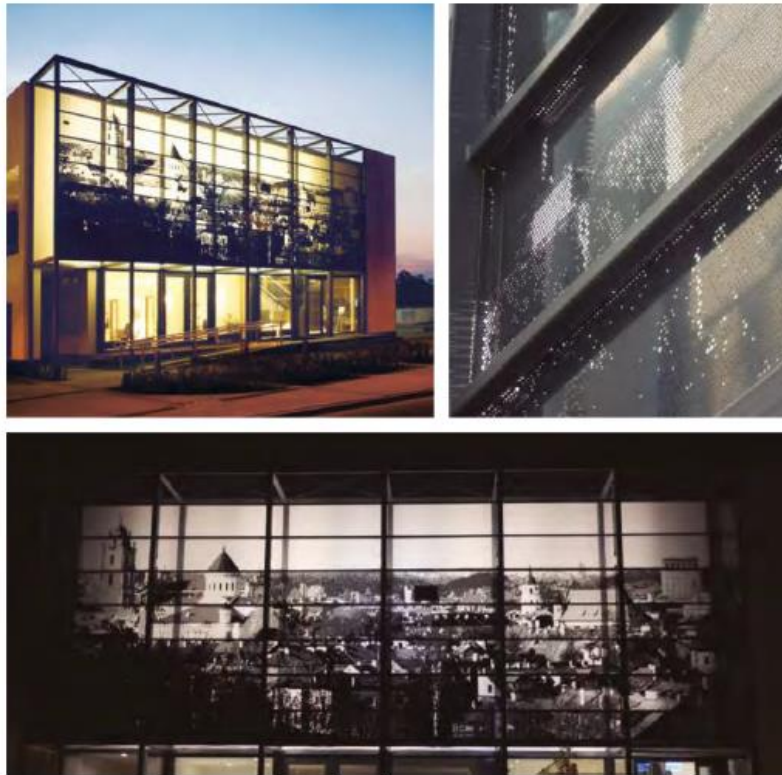
Figura 14. Ejemplo de perforaciones realizadas con punzonadora.
