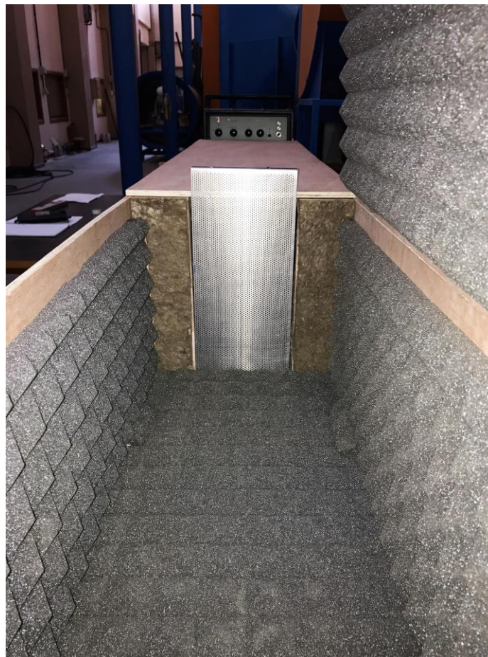
Figura 42. Colocación de una chapa para la medición con la tapa superior de la cámara abierta.
