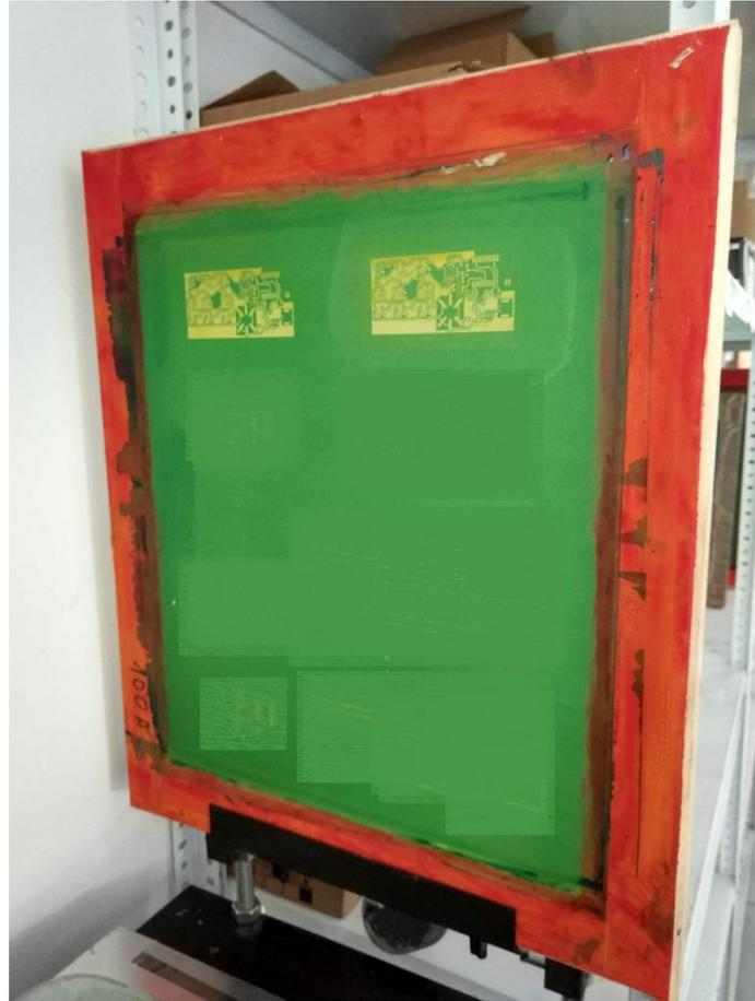
**Figura 27: Pantalla de serigrafía con el dibujo del circuito**
