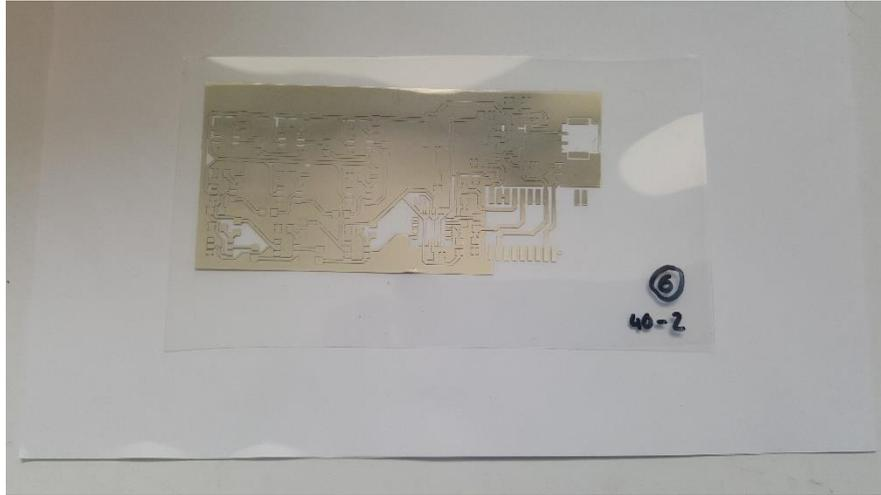
**Figura 25: Muestra tras superar el proceso de curado**
