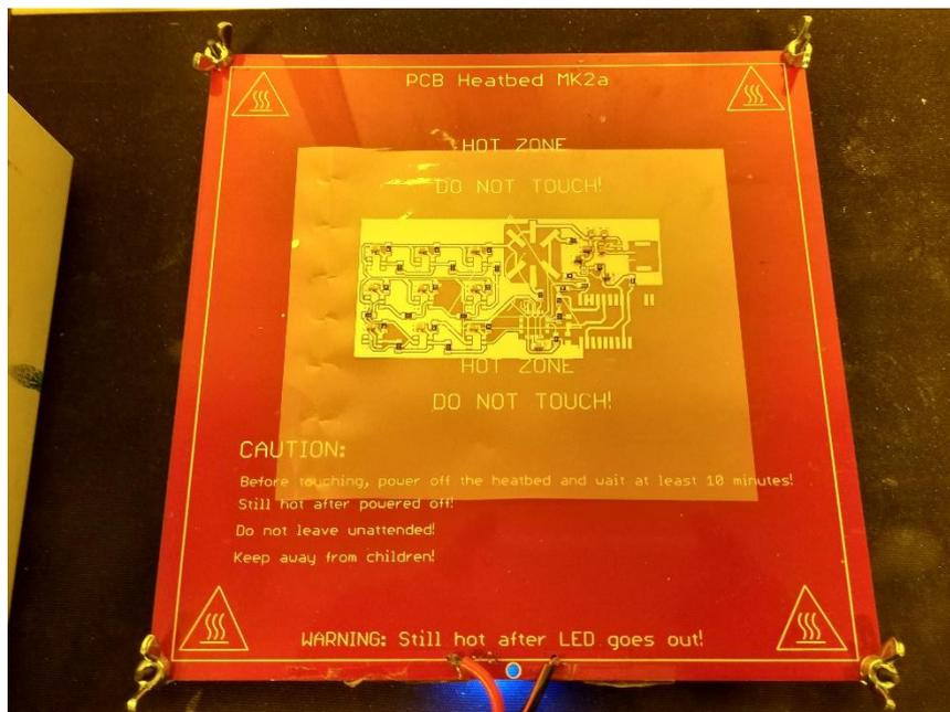
Figura 30: Cama caliente MK2a empleada en funcionamiento
