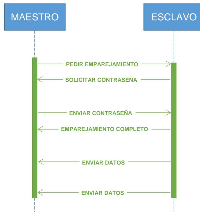
Figura 19: Diagrama de secuencia de la comunicación implementada
