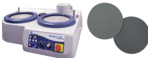
Fig 21. Equipamiento de pulido mecánico con papeles de SiC
