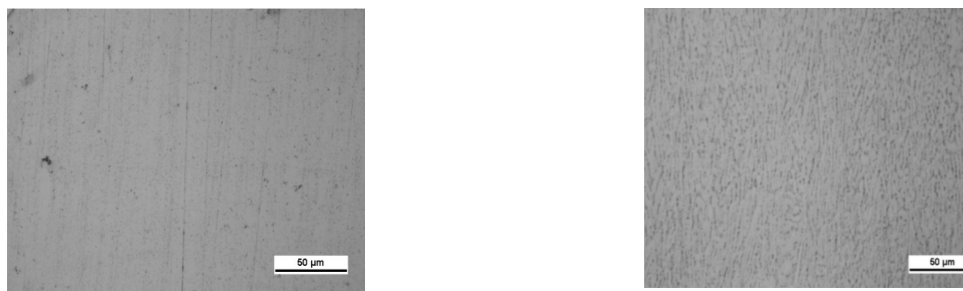
Fig23. a/ LMPD pulido con pulido mecánico con sílice coloidal b/ LMPD pulido con electro-pulido con los parámetros óptimos de pulido (20V, 10s) y sin grabado.
