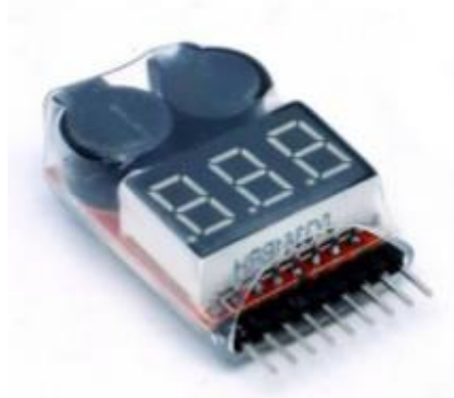
Ilustración 49: Voltímetro con alarma sonora para el control redundante del nivel de batería.
