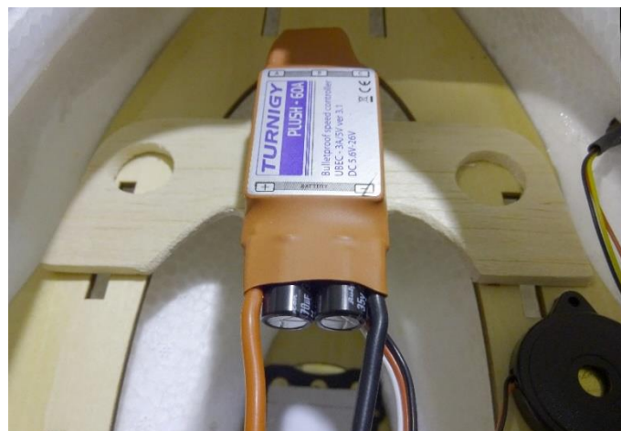
Ilustración 26: Variador fijado en la bahía superior.
