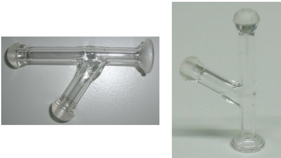
Figura25 : Detalle de la pieza 2 de conexión de acoplamiento entre cámara de nebulización al CG-ICP-MS no ensayada
