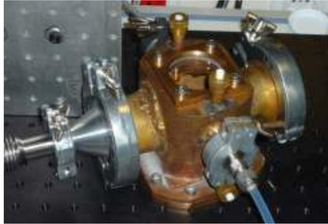
Figura 21. Celda de ablación
