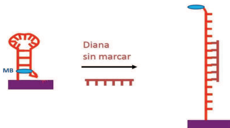
Figura 9. Esquema de un ensayo de hibridación signal-off .
