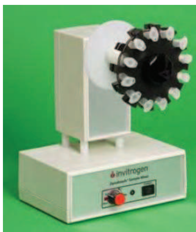
Figura 13. Rueda de mezcla para eppendorf de 1.5 mL
