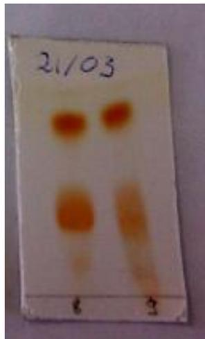
**Fig. 29:** Imagen de la placa TLC en Acetato de etilo/éter de petróleo 2/8 (v/v) realizada a las 24 h de la reacción. (En la imagen, “8” significa productos obtenidos a partir de  $\text{FcCO}(\text{CH}_2)_5\text{Br}$  en presencia de  $\text{K}_2\text{CO}_3$  y éter 18-corona-6; “9” significa productos obtenidos a partir de  $\text{FcCO}(\text{CH}_2)_5\text{I}$  en presencia de  $\text{K}_2\text{CO}_3$  sin éter 18-corona-6).
