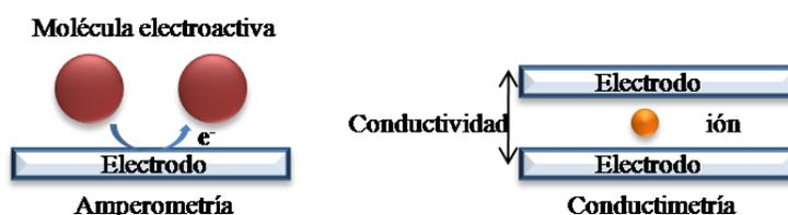
**Fig. 2:** Dibujo explicativo de la detección amperométrica (reducción) y conductimétrica.
