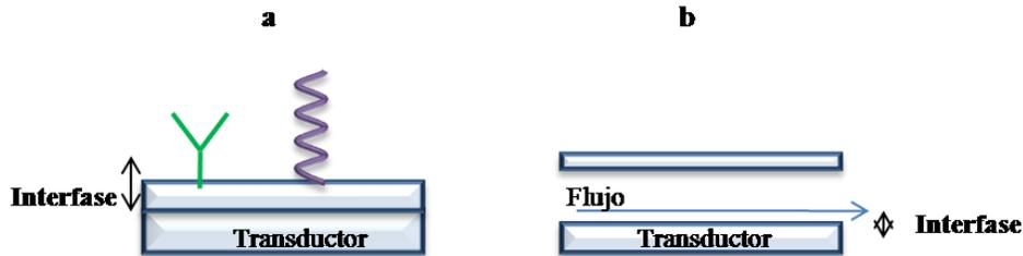
**Fig. 1:** Ejemplos de interfaces transductor-disolución en un biosensor (a) y en un microchip de electroforesis (b).
