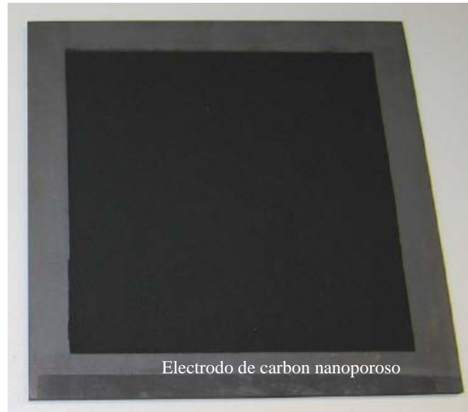
Fig. 2.25. Celda CDI desarrollada construida a partir de electrodos de grafito recubiertos con carbón nanoporoso
