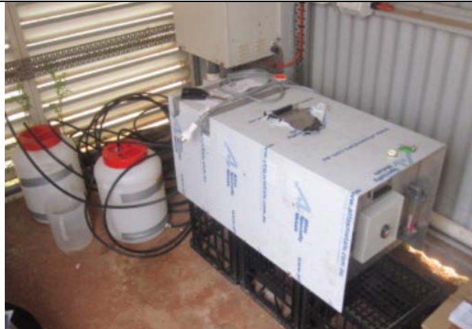
Fig. 2.14. Prototipo de planta CDI. La limpieza se realiza con ácido cítrico 0.01M/l +hidróxido sódico 0.01M/l (para limpieza de material orgánico) en un volumen de 20 litros respectivamente [24], [25].
