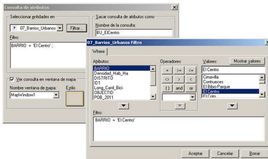
Figura 103. Ventana de diálogo para obtener el barrio 'El Centro' de forma independiente
