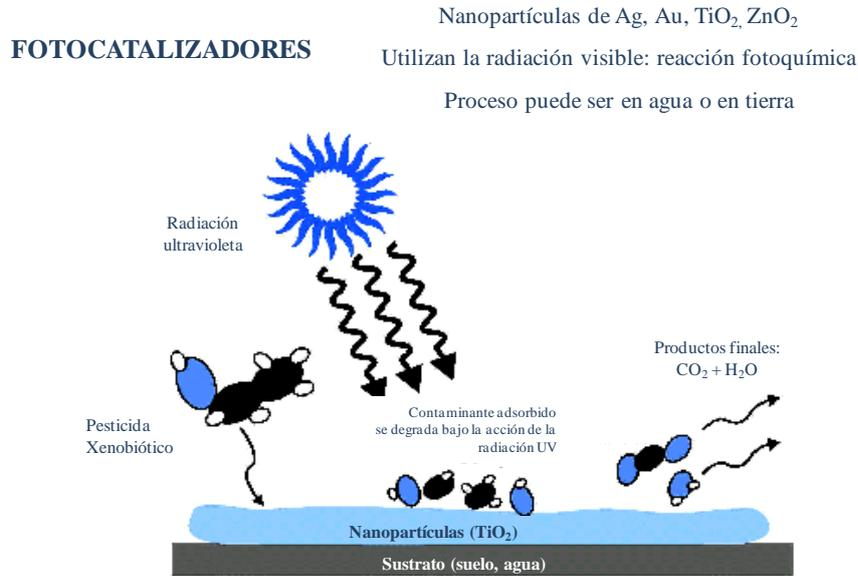
**Figura 5 Recuperación medioambiental empleando nanopartículas de TiO<sub>2</sub>**
