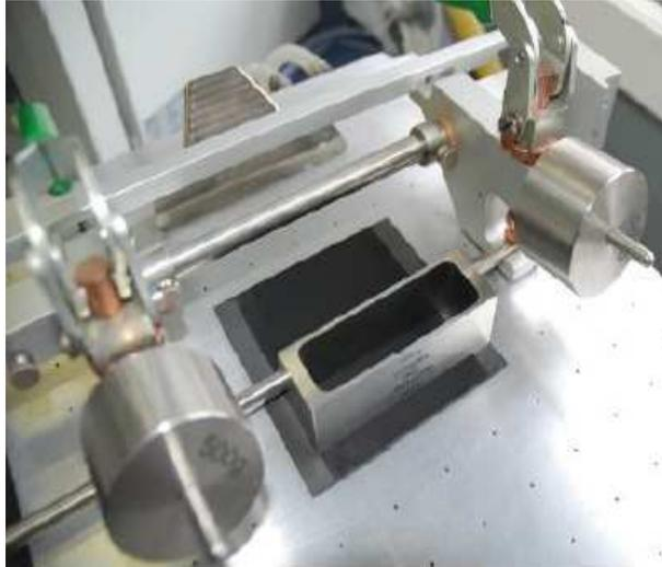
**Figura 3.2.- Imagen del equipo *Elcometer 4340* empleado para realizar *tape-casting*.**
