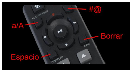
Figura 53: Mando "remote # 3". Experimentación 4. Teclas de cambio a mayúsculas y caracteres especiales y teclas de espacio y borrar.
