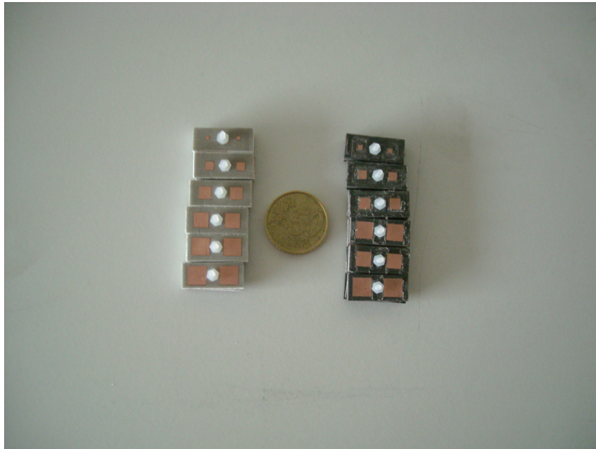
Figura 7.12: Detalle de los prototipos de celda fabricados para los dos diseños.
