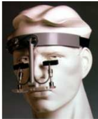
Fig. 11. Sistema de videooculografía con cámara fija a la cabeza [8].
